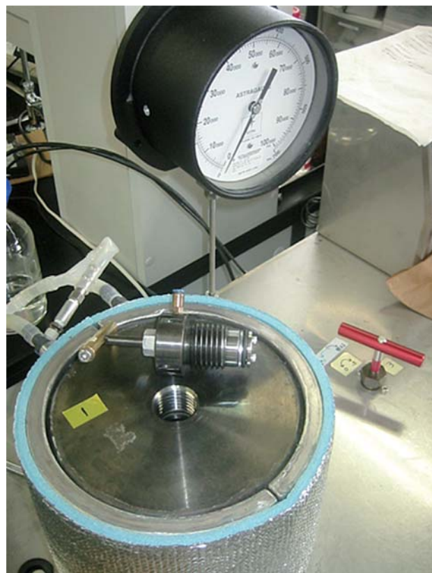
超高压装置 円筒の中心の空間を6000気圧まで加圧することができる
