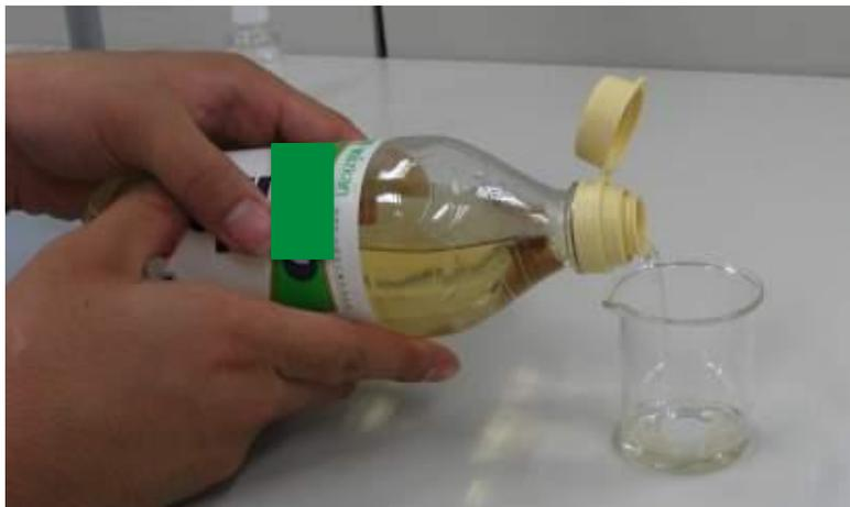
与えられた食酢原液を10 mLより少し多めにビーカーに加える。安全ピペッターを取り付けたホールピペットを用い、安全ピペッターのダイヤルを回して食酢を吸い上げる。この時、ビーカーを少し傾けて液を片寄せさせる。ホールピペットの標線に合わせて、正確に10 mLを量り取る。ホールピペットで吸い上げる時には、空気を吸い上げないように注意する。
