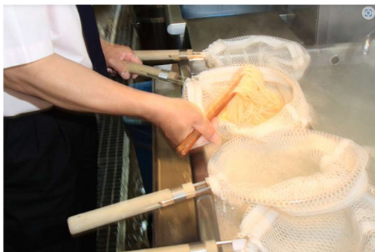
写真 2-3 大手うどんチェーンの協力のもと改良をかさねた讃岐たも
