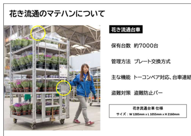
図3-5 統一規格台車の構造と RFID タグによる管理システム
