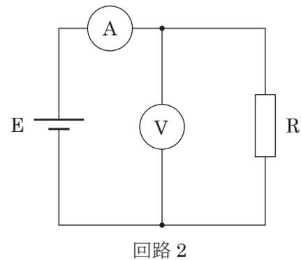
(1) 抵抗  $R$  にかかる電圧を測定するには、回路 1 と回路 2 のどちらの回路が適切か。
